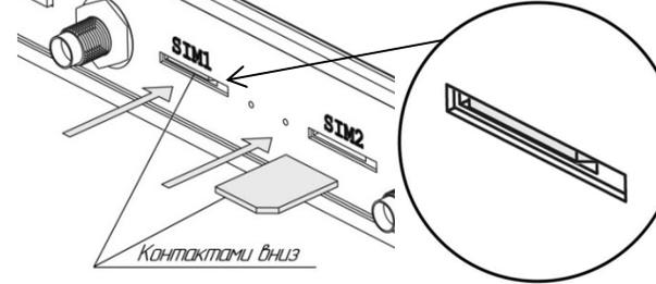
Установку SIM-карты в слот необходимо производить с небольшим усилием, дальше передней панели роутера до характерного щелчка. **Не допускается использование острых предметов (игла, пинцет и т. д.) для установки SIM-карты, в виду возможной деформации разъёма.**
