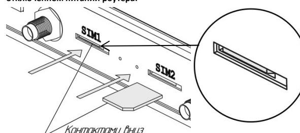
Установку SIM-карты в слот необходимо производить с небольшим усилием, дальше плоскости передней панели до характерного щелчка. **Не допускается использование острых предметов (игла, пинцет и т. д.) для установки SIM-карты, в виду возможной деформации разъёма.**
